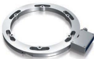
2000 系列为无轴承增量式编码器环，适用于轴尺寸非常大的情况。2000 系列可接受高达 2.6 mm 的空气间隙，性能要比市场上大多数环产品高出数倍。Leine & Linde 环被分割为若干个段，从而便于调试和维修。由于该环
